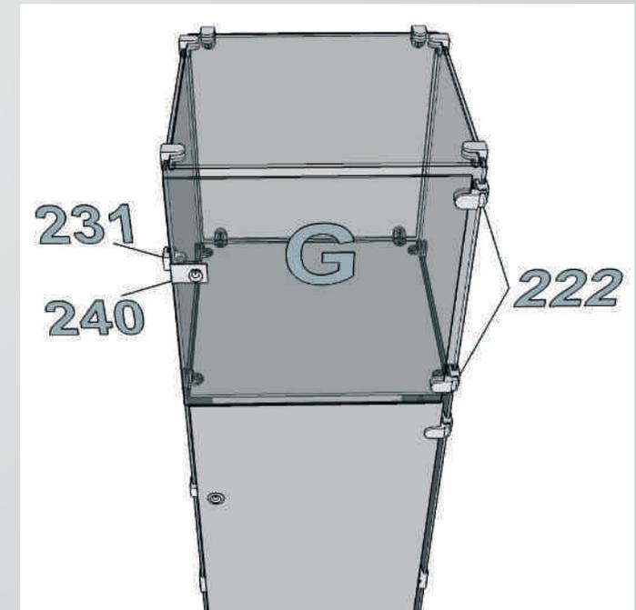
Befestigen Sie die Scharniere (Nr. 222) an der Türe (G) und befestigen Sie diese am Korpus des Glaskubus.
