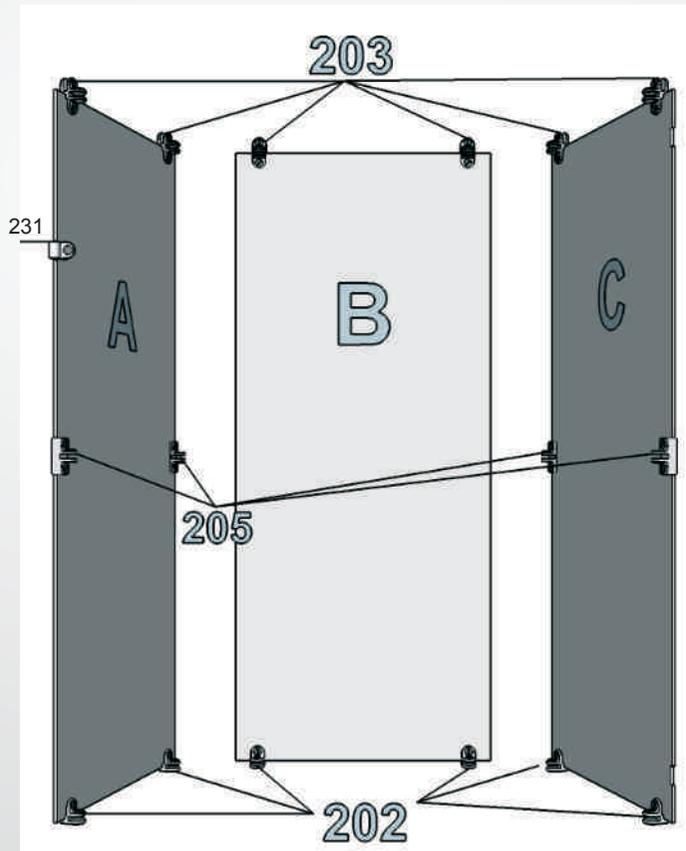
Montieren Sie die Verbinder an den ausgestanzten Stellen der Sockelplatten.
