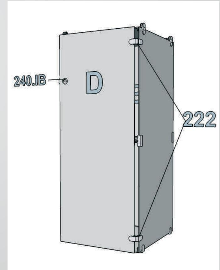
Befestigen Sie die Scharniere (Nr. 222) an der Türe (D) und befestigen Sie diese am Korpus des Sockels.
