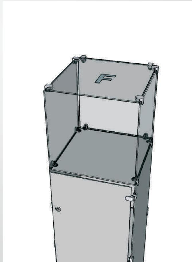
Schieben Sie nun die Glasplatte (F) in die Verbinder ein und ziehen Sie die Schrauben an.
