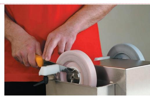
Die integrierte Wasserkühlung dieser Schleifmaschine verhindert das Überhitzen der Schneide.
