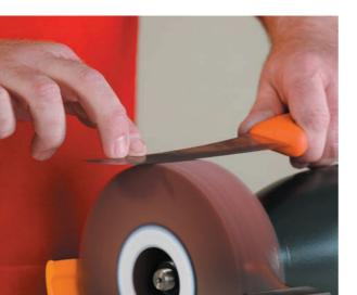
Um die Klingenschärfe zu optimieren, wird nach den Schleifdurchläufen mit einem Handschärfgerät oder einem Polierstahl der Faden auf der Schneide positioniert beziehungsweise nochmals verfeinert. Die Klinge ist nach wenigen Zügen perfekt geschärft.
