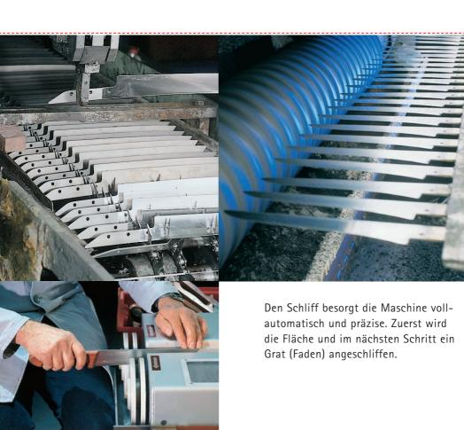
Für den Glanz sorgt die Poliermaschine. So wird die Klingenoberfläche makellos glatt. Und das hat viele Vorteile: Rost kann sich nicht festsetzen und die Klinge ist leicht zu reinigen.
