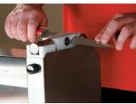
Dieser Diamant-Messerschärfer erzielt den balligen Schliff der Schneide durch eine patentierte Technik mit federnden, diamantbelegten Klingen.
