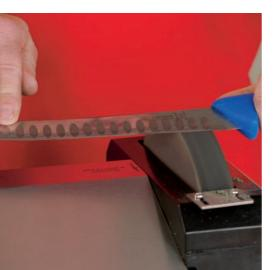
Nach dem Schleifdurchlauf wird Polieroder Abziehpaste auf die Polierscheibe aufgetragen. Mit sanftem Druck wird die Klinge mehrfach von beiden Seiten über die Polierscheibe geführt.
