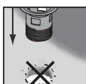
Veuillez vous assurer qu'il n'y a pas de saleté sur le bord du trou lors de l'installation du godet de vidange. Les pics de tensions localisés dus au contact entre certains matériaux durs tels que le métal peuvent rapidement entraîner une rupture.
