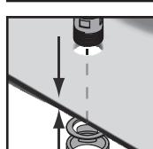
Aby uniknąć pęknięć naprężeniowych w obszarze armatury i odpływu, zaleca się zastosowanie odpowiedniego materiału uszczelniającego (wkładki gumowe lub z tworzywa sztucznego) lub trwałej plastycznej masy uszczelniającej z tworzywa sztucznego (zestaw montażowy do wody ciepłej i zimnej). Upewnić się, że materiał mocujący jest odpowiedni do zastosowania na umywalece.
