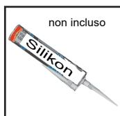
Montare il lavabo con il silicone sanitario secondo la fase di montaggio. Questo serve a garantire la sicurezza, a compensare le irregolarità e a prevenire i danni causati dall'acqua.
