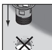
Podczas montażu spustu umywalki należy zwrócić uwagę, czy na krawędzi otworu nie ma zanieczyszczeń. Miejscowe naprężenia spowodowane kontaktem z twardymi materiałami, takimi jak metal, mogą szybko doprowadzić do pęknięcia.
