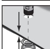
Per evitare fessure da tensione nella zona del raccordo e dello scarico, si raccomanda di utilizzare un materiale di tenuta appropriato (inserti in gomma o plastica) o un composto di tenuta permanente in plastica (kit di installazione per acqua calda e fredda). Assicurarsi che il materiale di fissaggio sia adatto al lavabo.
