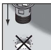
Podczas montażu spustu umywalki należy zwrócić uwagę, czy na krawędzi otworu nie ma zanieczyszczeń. Miejscowe naprężenia spowodowane kontaktem z twardymi materiałami, takimi jak metal, mogą szybko doprowadzić do pęknięcia.
