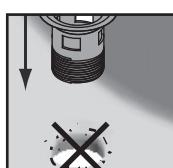
Durante l'installazione del calice di scarico, accertarsi che non vi sia sporcizia sul bordo del foro. I picchi di tensione locali dovuti al contatto con materiali duri come il metallo o il vetro possono portare rapidamente alla rottura.
