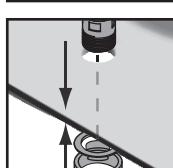
A csap és lefolyó területén a feszültség okozta repedések elkerülése érdekében ajánlott megfelelő tömítőanyagot (gumi vagy műanyag betétek), illetve tartósan plasztikus tömítőmasszát (hűtő- és melegvízes kitt tömítés) használni. Ügyeljen arra, hogy a rögzítőanyag alkalmas a mosdókagyló számára történő alkalmazásra.
