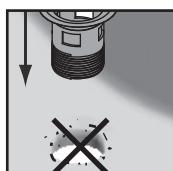
Dbajte na to, aby sa pri montáži odtokového ventiliu nenachádzali na okraji otvoru žiadne nečistoty. Lokálne zvýšene napätie vyplývajúce z kontaktu s tvrdými materiálmi ako je kov môže rýchlo viesť k rozbitiu.
