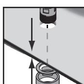
A csap és lefolyó területén a feszültség okozta repedések elkerülése érdekében ajánlott megfelelő tömítőanyagot (gumi vagy műanyag betétek), illetve tartósan plasztikus tömítőmasszát (hideg- és melegvízes kitt tömítés) használni. Ügyeljen arra, hogy a rögzítőanyag alkalmas a mosdókagyló számára történő alkalmazásra.
