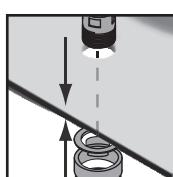
Za preprečevanje razpok zaradi napetosti v območju armature in odtoka se priporoča uporaba ustreznega tesnilnega materiala (gumijaste ali plastične podložke) oz. trajne plastične tesnilne mase (namestitveni komplet za vročo in mrzlo vodo). Pazite, da je pritrilni material primeren za uporabo na umivalniku.
