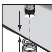
Zum Vermeiden von SpannungsrisSEN im Armatur- und Ablaufbereich wird empfohlen, entsprechendes Dichtungsmaterial (Gummi- oder Kunststoffbeilagen) bzw. dauerplastische Dichtungsmasse (Installationskit für Heiß- und Kaltwasser) zu verwenden. Achten Sie darauf, dass das Befestigungsmaterial für den Einsatz am Waschbecken geeignet ist.
