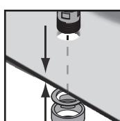
U svrhu izbjegavanja pukotina uslijed naprezanja u području armature i odvoda, preporučuje se upotreba odgovarajućeg brtvenog materijala (gumenih ili plastičnih dodataka), odnosno trajno plastične brtvene mase (instalacijski komplet za hladnu i vruću vodu). Pazite na to da pričvrsti materijal bude prikladan za upotrebu na umivaoniku.
