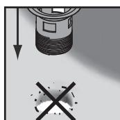
Obratite pozornost na to da se tijekom ugradnje nastavka za odvod na rubu otvora ne nalaze nikakva onečišćenja. Lokalni vršni naponi uslijed kontakta s tvrdim materijalima, kao što je dodir s metalom, brzo mogu dovesti do loma.
