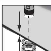
Odporúčame použiť vhodný tesniaci materiál (gumené alebo plastové príložky), resp. trvalo plastický tesniaci tmel (inštalačná súprava pre horúcu a studenú vodu), aby sa predišlo vzniku trhlín spôsobených napätiom v oblasti armatúry a odtoku. Dbajte na to, aby bol upevňovací materiál vhodný pre použitie na umývadle.
