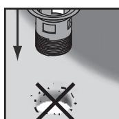
Dbejte prosím na to, aby se po namontování odtokového ventilu nenacházely na okraji otvoru žádné nečistoty. Lokální vyšší tlak v důsledku kontaktu s tvrdými materiály, jako je kov, může rychle vést k rozbití.
