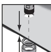
Gebruik geschikt afdichtingsmateriaal (rubberen of kunststof inzetstukken) of een blijvend elastische afdichtingskit (montagekit voor warm en koud water) om spanningsscheuren in de kraan en de afvoer te voorkomen. Zorg ervoor dat het bevestigingsmateriaal geschikt is voor het gebruik aan de wastafel.
