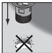
Zorg ervoor dat er geen vuil op de rand van het gat zit bij het installeren van het afvoerputje. Plaatselijk hoge spanning door contact met harde materialen, zoals metaal, kan snel tot breuken leiden.
