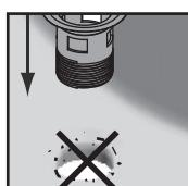
Dbajte na to, aby sa pri montáži odtokového ventílu nenachádzali na okraji otvoru žiadne nečistoty. Lokálne zvýšene napätie vyplývajúce z kontaktu s tvrdými materiálmi ako je kov môže rýchlo viesť k rozbitiu.
