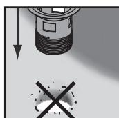
Achten Sie bitte darauf, dass beim Einbau des Ablaufkelchs keinerlei Verschmutzungen am Rand des Loches vorliegen. Lokale Spannungsspitzen aus Kontakt mit harten Materialien wie Metall können schnell zum Bruch führen.
