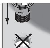
Zorg ervoor dat er geen vuil op de rand van het gat zit bij het installeren van het afvoerputje. Plaatselijk hoge spanning door contact met harde materialen, zoals metaal of glas-glas-contact, kan snel tot breuken leiden.
