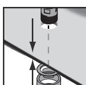
Pour éviter les fissures dues à des tensions dans la zone de raccordement et de vidange, nous recommandons d'utiliser un matériau d'étanchéité approprié (inserts en caoutchouc ou en plastique) ou un composé d'étanchéité en plastique permanent (kit d'installation pour eau chaude et froide). Assurez-vous que le matériel de fixation est adapté à une utilisation pour l'évier.
