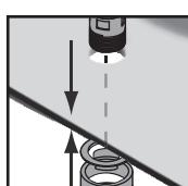
A csap és lefolyó területén a feszültség okozta repedések elkerülése érdekében ajánlott megfelelő tömítőanyagot (gumi vagy műanyag betétek), illetve tartósan plasztikus tömítőmasszát (hűtő- és melegvízes kitt tömítés) használni. Ügyeljen arra, hogy a rögzítőanyag alkalmas a mosdókagyló számára történő alkalmazásra.
