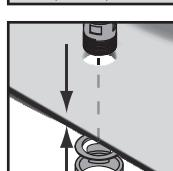
Aby uniknąć pęknięć naprężeniowych w obszarze armatury i odpływu, zaleca się zastosowanie odpowiedniego materiału uszczelniającego (wkładki gumowe lub z tworzywa sztucznego) lub trwałej plastycznej masy uszczelniającej z tworzywa sztucznego (zestaw montażowy do wody ciepłej i zimnej). Upewnić się, że materiał mocujący jest odpowiedni do zastosowania na umywalece.
