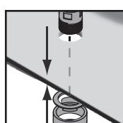
Aby uniknąć pęknięć naprężeniowych w obszarze armatury i odpływu, zaleca się zastosowanie odpowiedniego materiału uszczelniającego (wkładki gumowe lub z tworzywa sztucznego) lub trwałej plastycznej masy uszczelniającej z tworzywa sztucznego (zestaw montażowy do wody ciepłej i zimnej). Upewnić się, że materiał mocujący jest odpowiedni do zastosowania na umywalce.
